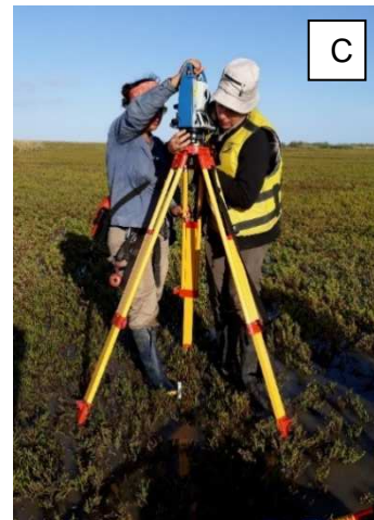
Fig. 3. 2. A) Esquema de la toma de datos con la estación total. B) Transecta típica de las marismas de Samborombón. C) Regulación de la estación total sobre el punto amojonado con el GPS diferencial.
