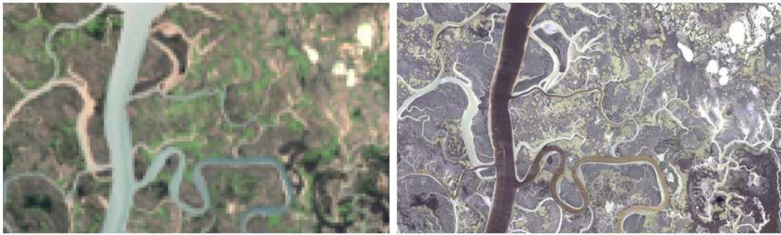
Fig. 2. 3. Comparación de imágenes de distinta resolución espacial en la zona de estudio. A la izquierda imagen Landsat 8 (resolución espacial=30 metros) y a la derecha imagen World-View 2 (resolución espacial=2 metros).
